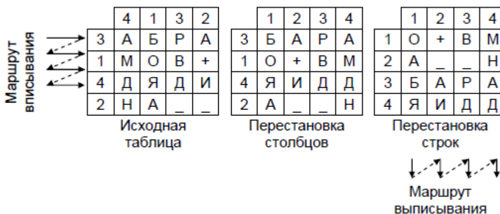
Рис.19. Пример использования шифра двойной перестановки
